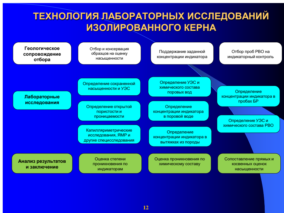
Рис.3. Схема лабораторных исследований изолированного керна.
